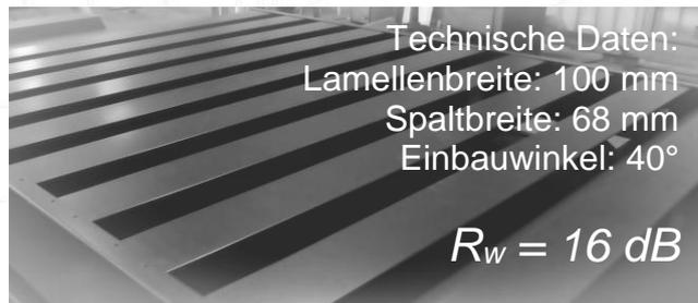
**Schalldämmmaß  $R_w$  eines doppelschaligen Wandaufbaus**
